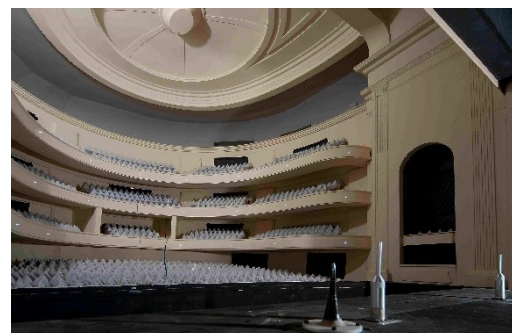
Abbildung 6: Bild im Maßstabsmodell mit der erhöhten Decke und Nachhallgalerie. Im Vordergrund eine rundum strahlende Hochfrequenzquelle und ein Mikrofon mit Vorverstärker.
