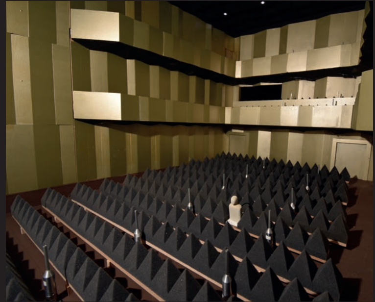
Akustisches Masstabmodell 1:10 zur Optimierung der Raumakustik
